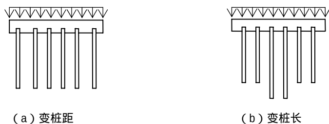
图 3.1 - 5 均布荷载下变刚度布桩模式
